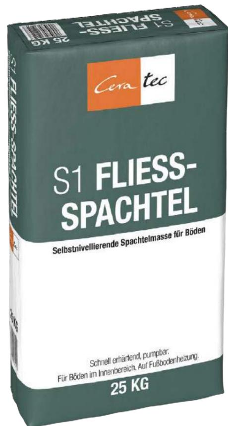
Selbstnivellierende, schnellerhärtende Ausgleichsmasse zur Egalisierung unebener Böden im Innenbereich bis 30 mm Schichtdicke. Ceratec S1 Fließspachtel ist ein selbstverlaufender, schnellerhärtender Bodenspachtel auf Zementbasis für trockene Innenbereiche, zum Ausgleich von Unebenheiten mit einer Schichtdicke von 2 – 30 mm.
